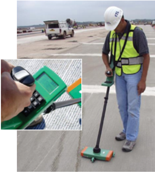
Figure 3.15. MIT Scan T2 device (Ye and Tayabji 2009)
